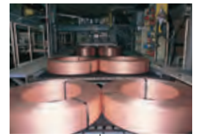
焼鈍により所定の機械的性質に仕上げていきます。
