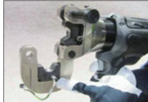
プレス工具に継手サイズに適合したダイスをセットして下さい。
