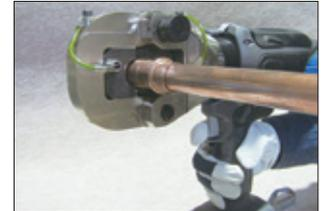
プレス工具を継手に垂直にセットしてプレス。LEDランプが点灯したら完了。リリースして下さい。
