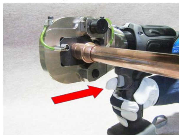
⑤ プレス開始－作動スイッチ(灰色)を押す
