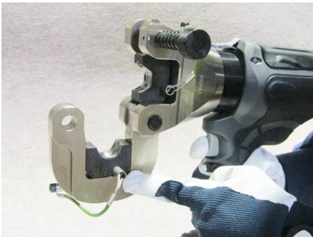
③ヨーク側へのダイスの取り付け
