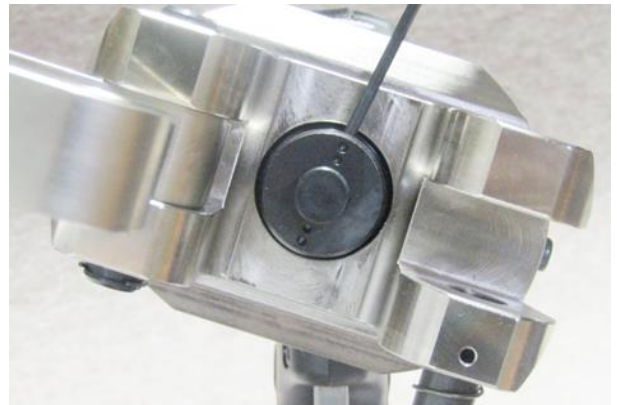
④付属六角ドライバーで増し締めする
