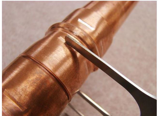
六角形変形部の対辺間隔を専用ゲージで判定
