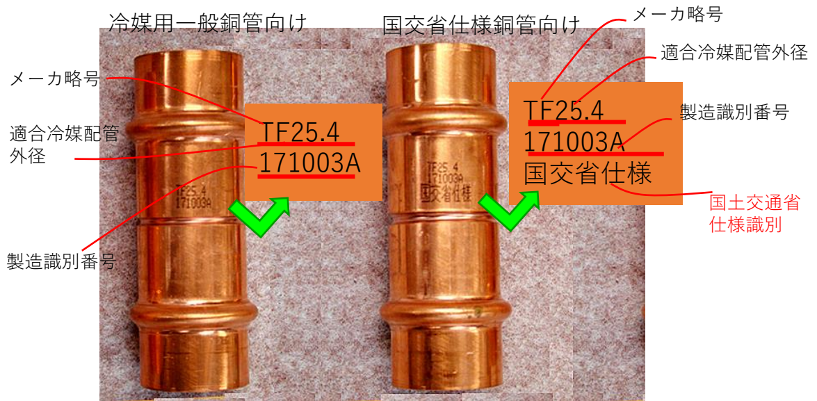
冷媒用一般銅管向けと国交省仕様銅管向けの識別
