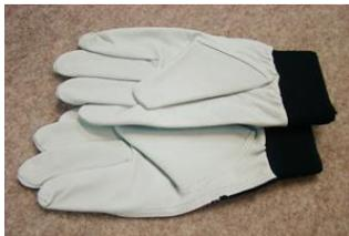
軍手等の繊維が脱落する手袋を使用した場合、脱落繊維片がシール面に入り込んで冷媒漏洩を生じさせる可能性があります。
