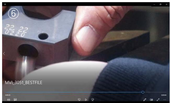
通常はこの状態でめねじ付きシャンクのヘッド部は容易に除去できます。除去できない場合はピストン部の除去と同様にM5のおねじをねじ込むことで除去できます。
