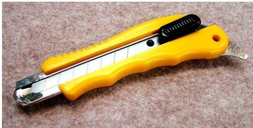
冷媒配管表面の爪に引っ掛かるような管軸方向のきずは冷媒漏洩の原因となります。冷媒管表面に刃先を当てない様こと。
