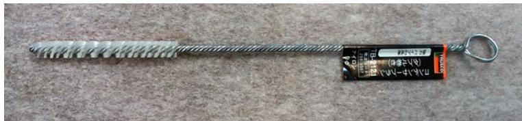
(5) 冷媒配管表面きず取り
