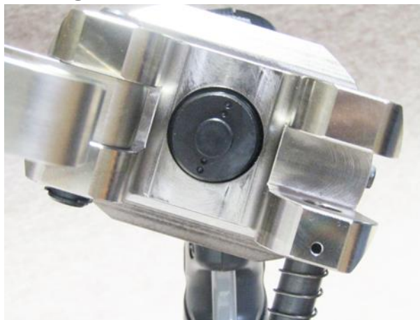
③作動スイッチを押してピストンを繰出す
