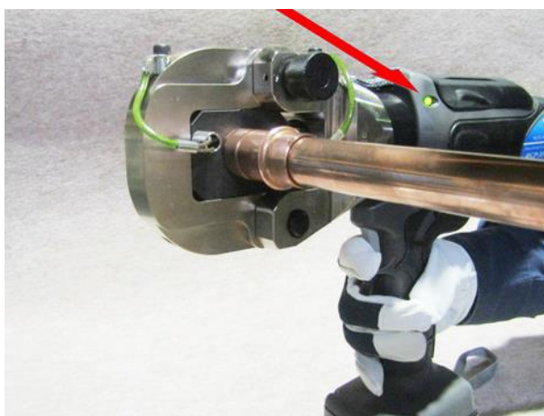
⑥ プレス完了－状態表示ランプが緑点灯
