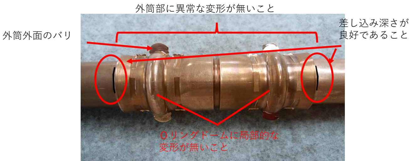
R G プレス6.35mm～19.05mm用の正常な施工完了状態
