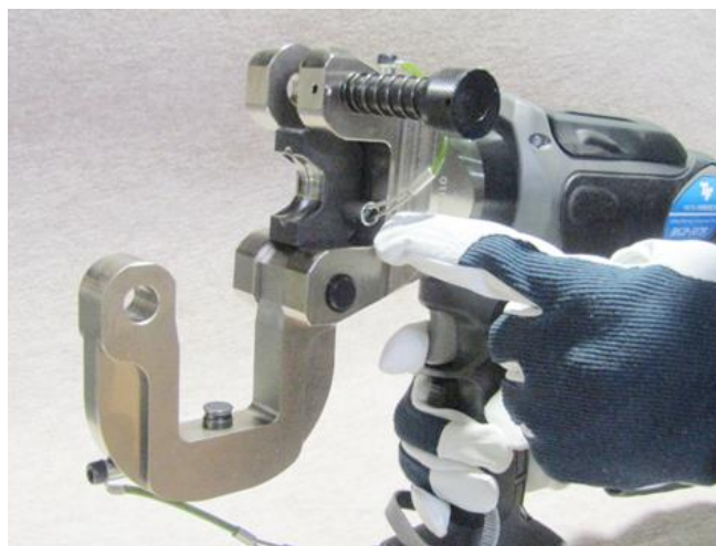
②ピストン側へのダイスの取り付け
